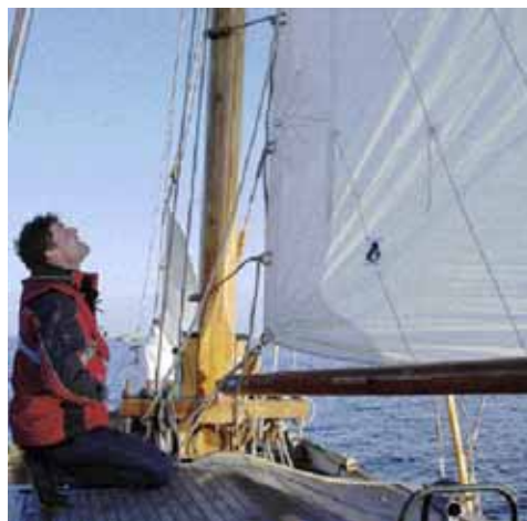
De halstalie is te strak doorgezet. Gevolg: een plooi vanuit de halshoek.
